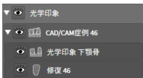
SICAT Implantでは複数のCAD/CAM事例をインポートできます。インポートした各CAD/CAM事例ごとにSICAT Implantはオブジェクトグループ**光学印象**内の**オブジェクトブラウザ**に対応する歯の位置とともに下位オブジェクトグループ**CAD/CAM事例**を表示します。オブジェクトグループ**CAD/CAM事例**には以下のオブジェクトを含むことができます。
