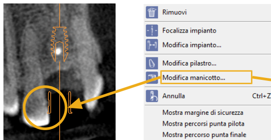
Figura 3: Collisione del manicotto con il dente adiacente
