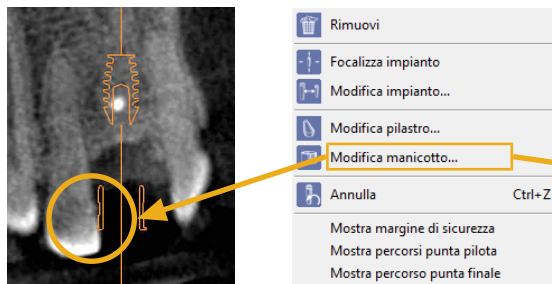
Figura 3: Collisione del manicotto con il dente adiacente
